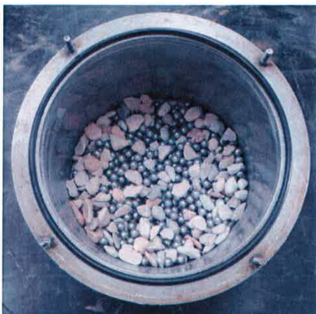
Figura 1 - Micro-Deval (tamburo rotante, campione e carica abrasiva)
