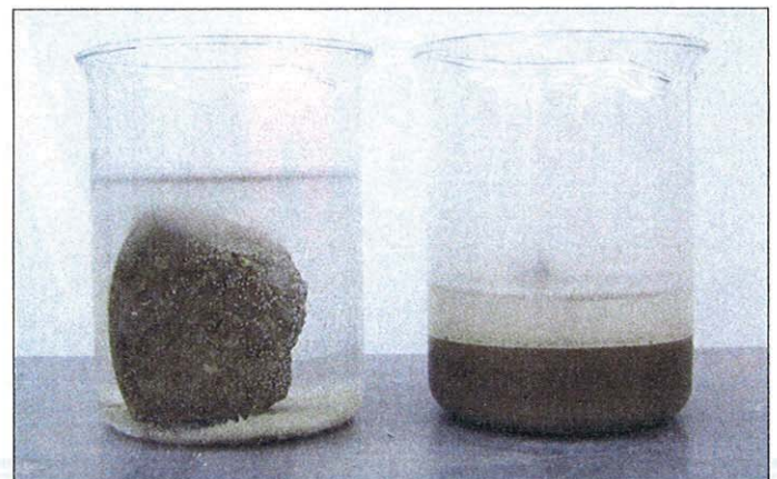
Figura 1 - Un terreno stabilizzato (a sinistra) e un terreno naturale (a destra) immersi in acqua
