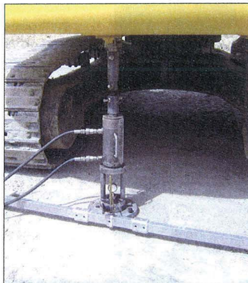
Figura 2 - La prova di carico su piastra
