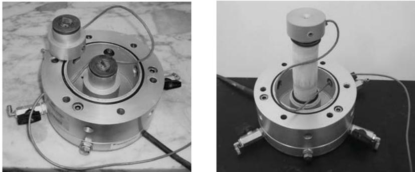
Fig. 1 - Trasduttori piezoelettrici a flessione in cella triassiale.
